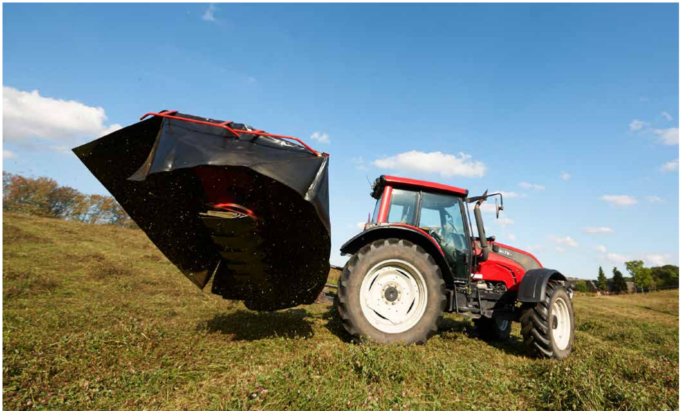
Der Aushub am Vorgewende erfolgt über einen Hydraulikzylinder.
