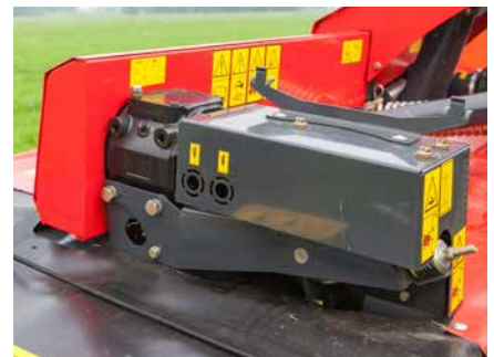
Die Schnecke wird über ein kleines Getriebe angetrieben. Der zusätzliche Leistungsbedarf beträgt lediglich 5 PS.
