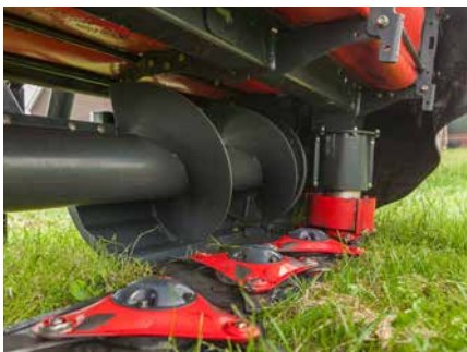
Aktiv angetriebene Schwadzusammenführung für ein perfektes Schwad.
