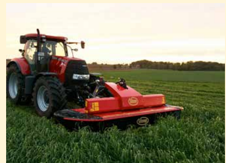
Durch Wechseln der Riemenscheiben kann mit 750 U/min gefahren werden. Dies spart Kraftstoff.
