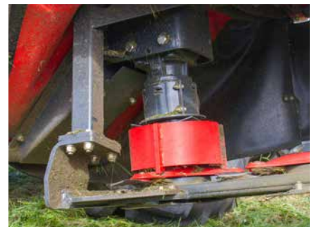
Direktantrieb vom Getriebe zur ersten Scheibe für effiziente Kraftübertragung.
