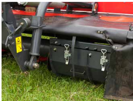
Die Schwadbreite wird einfach über verstellbare Leitbleche eingestellt.
