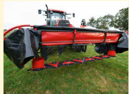
Optimaler Zugang zum Mähbalken durch klappbaren Front- und Seitenschutz.
