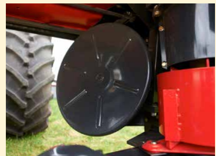
Die Maschinen können mit zwei Schwadscheiben ausgestattet werden. Sie ermöglichen Schwadbreiten von 2,20-2,40 m.
