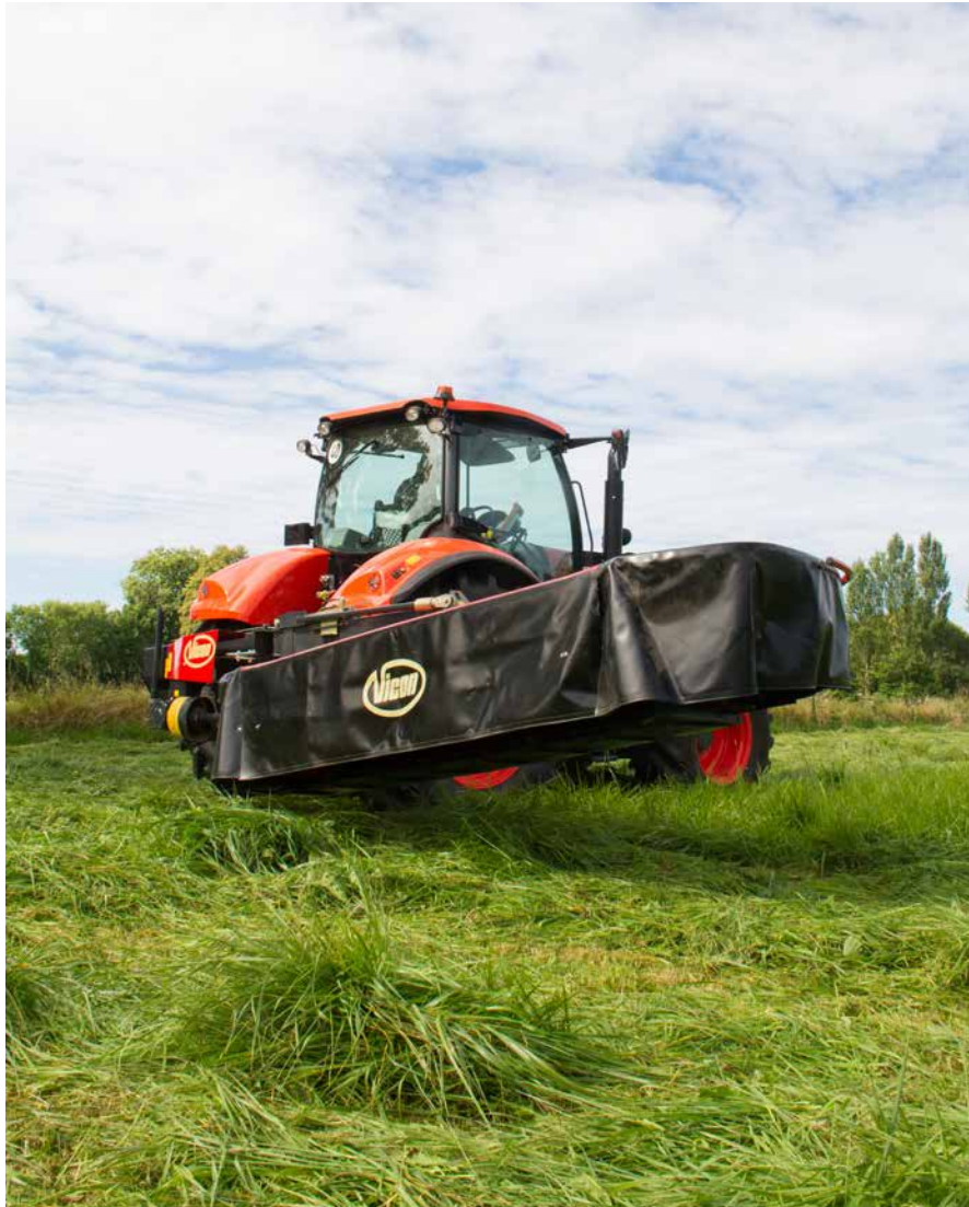
Hydropneumatische Bodendruckentlastung und perfekte Boden Anpassung.
