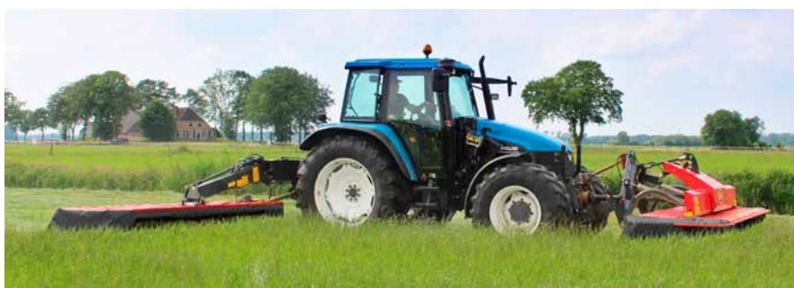
Die mittige Aufhängung des Mähbalkens sorgt für perfekte Boden Anpassung.
