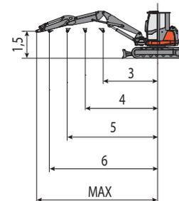
La capacità di sollevamento è basata sulla norma ISO 10567 e non eccede oltre il 75% del carico statico di ribaltamento o dell'87% della capacità di sollevamento idraulico della macchina.
