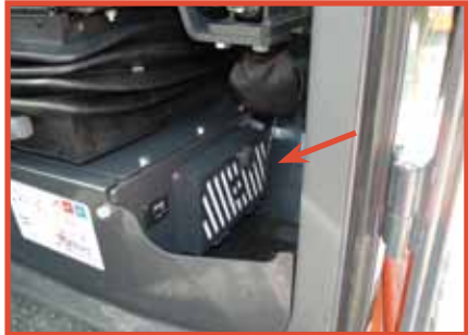
Artikel-Aufbewahrungsbehälter in der Kabine und Umluftfilter.
