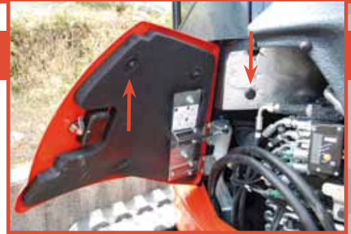
Innenbeschichtungen befestigt mittels Kunststoffpins (nicht nur geklebt).
