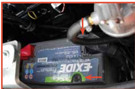
Wartungsfreie Batterie mit Ladestandanzeige. Selbstentlüftende Elektropumpe für das Einspritzsystem.
