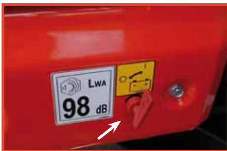
Batterieabklemmschlüssel vermeidet elektrische Verluste bei langen Stillstandzeiten.
