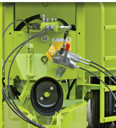
Cambio a due velocità di rotazione coclea, anche con leva in cabina trattore (optional)
