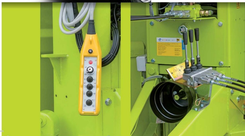
Due tipologie di comandi: elettrici (a sinistra) e meccanici flessibili al trattore (a destra)
