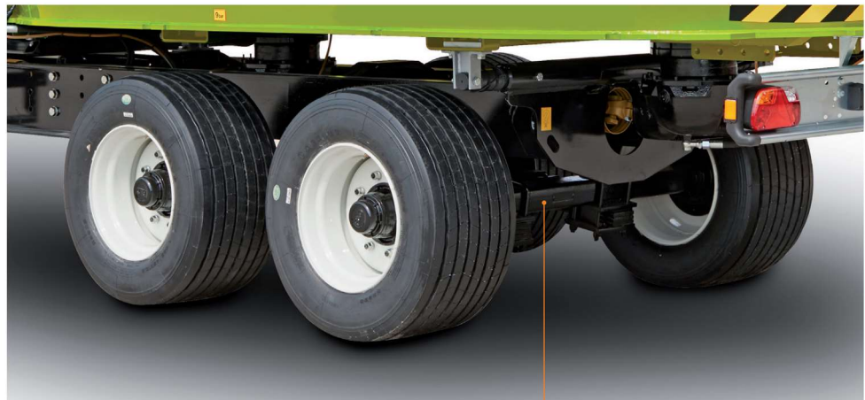
Nuovo bogie balestrato, disponibile in versione fissa ed autosterzante sia sui dunker T2S che T2L New sprung bogie, available also in self-steering version, both on dunker T2S and T2L Nuevo bogie con suspensiones, también en versión autoguiada, disponible en el dunker T2S y T2L
