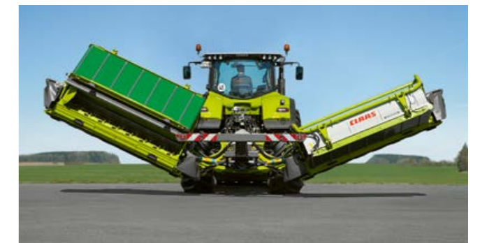
El control profesional permite la elevación individual y el pliegue individual.
