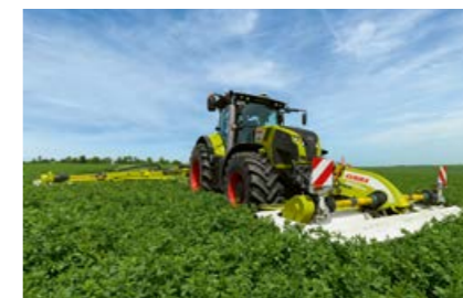
Opciones adicionales para la segadora frontal, p.ej. control del régimen de revoluciones, control ACTIVE FLOAT y pliegue del peto protector.
