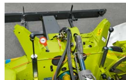
Manómetro para el fácil ajuste de la presión de apoyo para las dos unidades segadoras.
