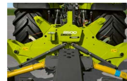
Soporte de enganche compacto y estable con sistema de descarga integrado de serie ACTIVE FLOAT.
