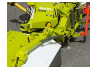
Protección en el caso de choque mediante el seguro anti-choque hidráulico Nonstop: La unidad segadora sale y se coloca por sí misma en la posición de salida.
