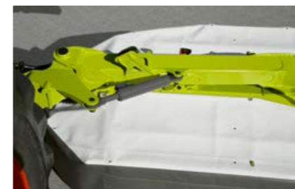
Protección en el caso de choque mediante el seguro antichoque hidráulico Nonstop – la unidad segadora sale y se coloca por sí misma en la posición inicial.
