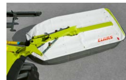
Ausklippen der mechanischen Anfahrtsicherung: Die Maschine weicht im Fall einer Kollision nach hinten und auch leicht nach oben aus (beim DISCO 1100 TREND hydraulische Nonstop-Anfahrtsicherung).
