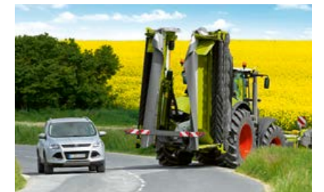
Unter 4 m: kompakte Transportposition mit gleichzeitig guter Bodenfreiheit bei beiden BUSINESS Modellen.
