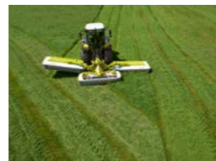
Einzelanhub der Mäheinheiten am Vorgewende.
