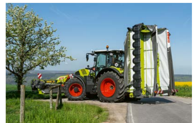
Unter 4 m Höhe und rundum kompakt wie alle DISCO Modelle: Vor dem Zusammenklappen werden einfach die beiden Mäheinheiten zusammen-teleskopiert.
