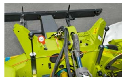
Ein Manometer zur einfachen Einstellung des Auflagedrucks für beide Mäheinheiten.
