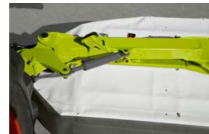
Schutz durch hydraulische Nonstopanfahrsicherung im Fall einer Kollision – Mäheinheit schwenkt aus und positioniert sich selbstständig in die Ausgangsposition.
