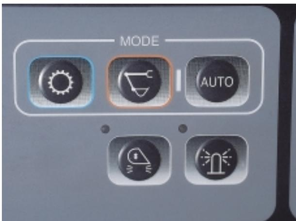
Der **Auto-Modus** der neuen CX290 vereinfacht das Fahren der Maschine erheblich, denn er ermöglicht eine automatische und permanente Anpassung (ohne Betätigung durch den Fahrer) der Arbeitsweise an die durchzuführende Arbeit.
