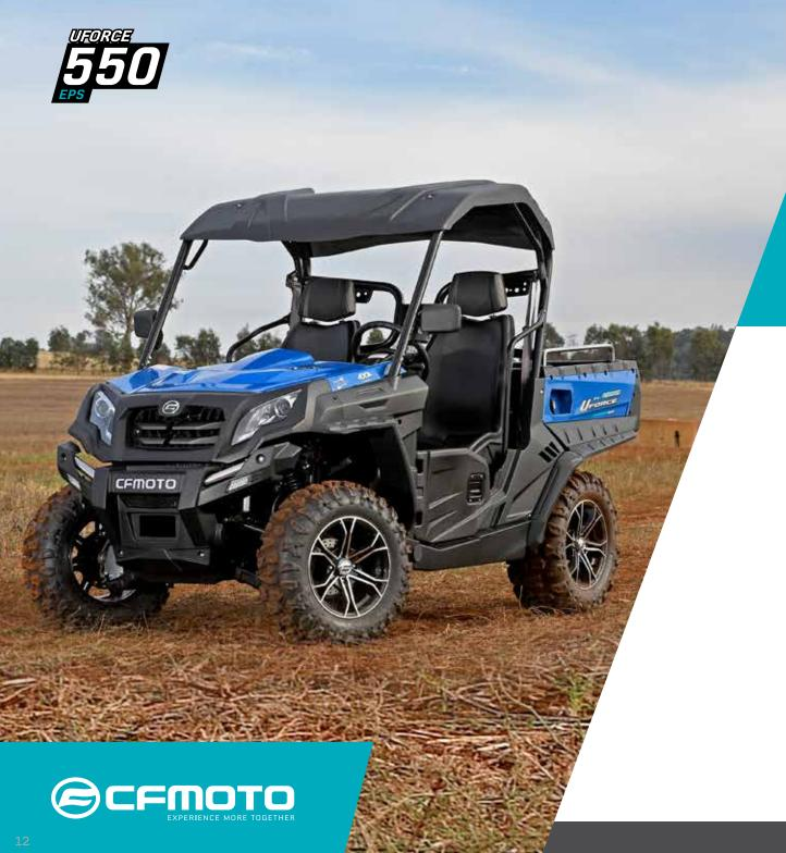
38 HORSEPOWER CFMOTO 500CC SINGLE CYLINDER ENGINE • CANADIAN CYTECH TRANSMISSION
