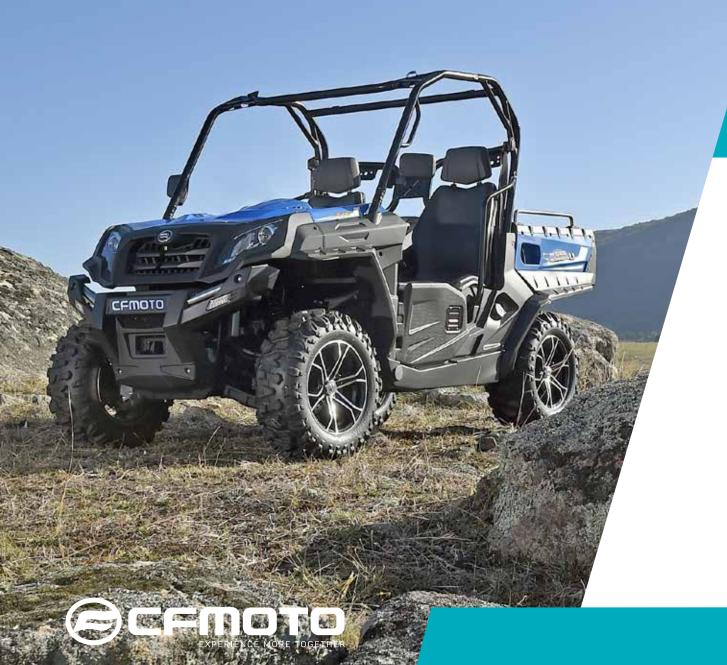
• 38 HORSEPOWER CFMOTO 500CC SINGLE CYLINDER ENGINE
