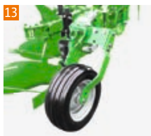
13 Ø da roda 600 mm rodas pneumáticas x 220 mm de largura – versão pesada (com braço duplo) Disponível para: Todas as charruas S e/ou V de 6 relhas e de 5 relhas
