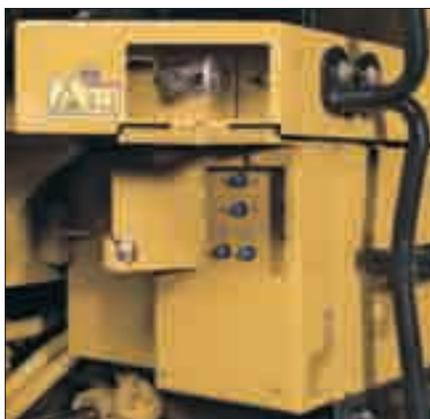
**Централизованный узел обслуживания электрооборудования.** Под левой площадкой доступа в кабину удобно сгруппированы аккумуляторные батареи, блок реле и дополнительный ящик для инструментов. В блоке реле размещен выключатель двигателя. Конструкцией самой площадки предусмотрен отсек, где располагается выключатель привода наклона капота, выключатель аккумуляторных батарей и разъем для запуска двигателя от внешнего источника тока (устанавливается по дополнительному заказу).
