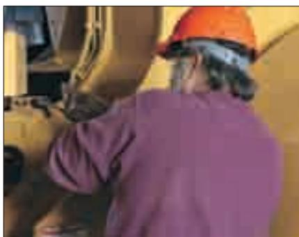
**Удобное расположение точек смазки.** Пресс-масленки сгруппированы с правой стороны машины в двух местах: в техническом отсеке, расположенном под правой площадкой обслуживания, и на площадке с наружной стороны рамы перед двигателем. Такое расположение облегчает смазку наиболее ответственных узлов, расположенных в разных частях машины.
