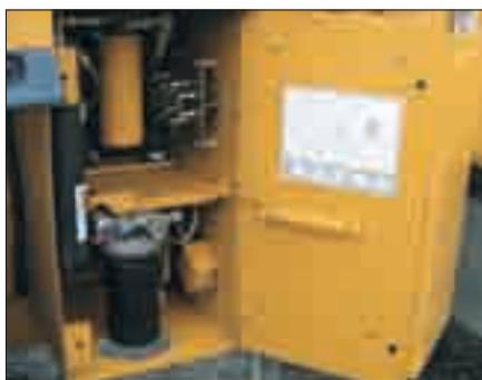
**Централизованный узел обслуживания гидравлики.** Центральный узел обслуживания гидравлики, расположенный за правой лестницей, объединяет масляные фильтры коробки передач и гидравлической системы. Для доступа к узлу обслуживания лестница откидывается на шарнирах. Там же расположен порт доступа к гидравлической системе, через который можно осуществить изменение уровня гидрожидкости в системе.
