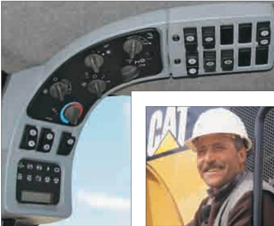
**Органы управления.** В погрузчике 966Н основная панель управления располагается под потолком на правой стойке устройства защиты при опрокидывании. С одной стороны, все органы управления под рукой, с другой — панель не загромождает обзор. Удобное расположение органов управления и переключателей обеспечивает высокую эффективность и производительность работы оператора, снижает его утомляемость.
