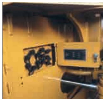
**Выносные штуцеры для замера давления.** Штуцеры для замера давления в контуре рулевого управления и гидравлической системе, а также в контурах трансмиссии (по заказу) и тормозной системы сгруппированы под правой площадкой обслуживания. Для доступа к штуцерам достаточно откинуть защитную крышку.
