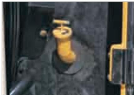
В боковых стенках капота имеются откидные крышки, открывающие доступ к визуальным указателям. Проверить уровень масла и охлаждающей жидкости в двигателе можно, не откидывая капот.
