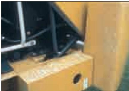
Для наклона капота предусмотрен специальный гидроцилиндр с механическим приводом. Кроме того, капот можно наклонить и вручную. Наклоняемый капот обеспечивает свободный доступ к моторному отсеку. При необходимости капот можно снять полностью — для этого он оборудован специальными проушинами.
