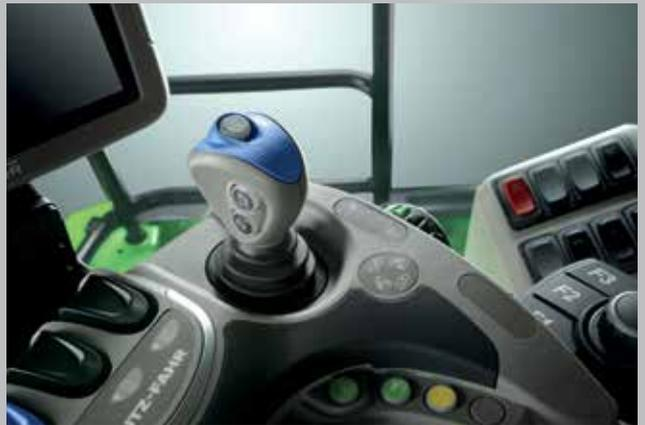
Joystick simple e intuitivo para controlar el sistema BALANCE. Función automática y manual, posición neutra y función de carretera. Posición ergonómica y cómoda, integrado en los mandos del reposabrazos.
