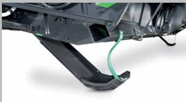
Patines robustos con sensores para controlar la posición del cabezal de corte en terrenos irregulares.
