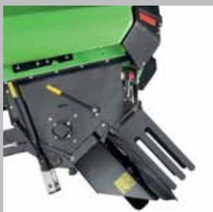
Picador de paja con 3 posiciones de regulación. La distribución de paja picada cubre todo el ancho del cabezal de corte en todas las condiciones.
