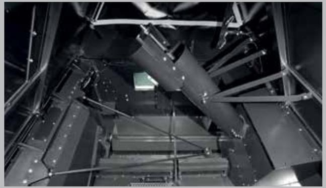
Gran sinfín de llenado. Dos sinfines de descarga en la tolva de grano para vaciarla rápidamente.
