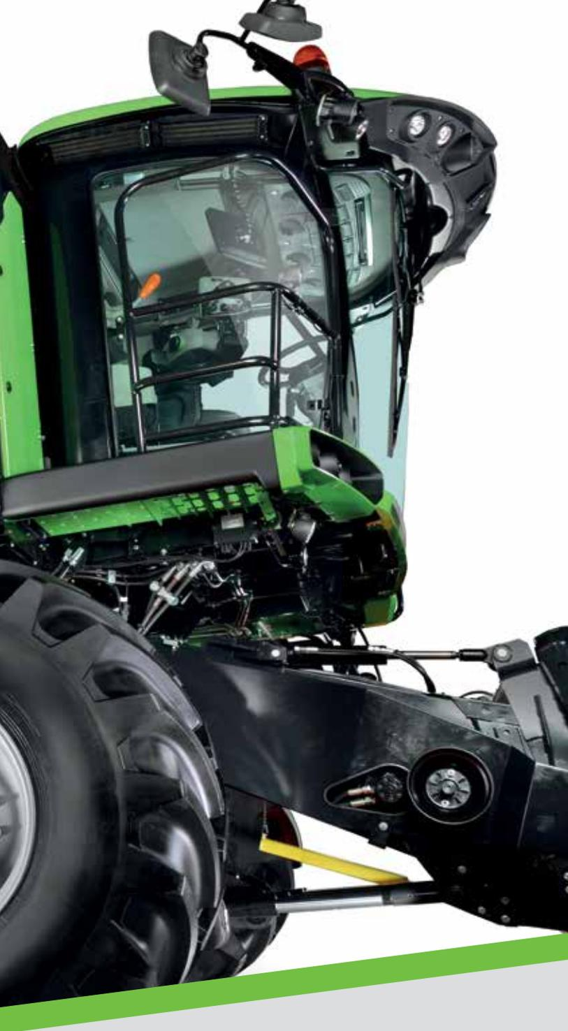
La amplia apertura de los paneles laterales permite un acceso completo a los principales sistemas de la cosechadora. En el lado derecho están situados todos los embragues mecánicos principales, así como los sistemas eléctricos.
