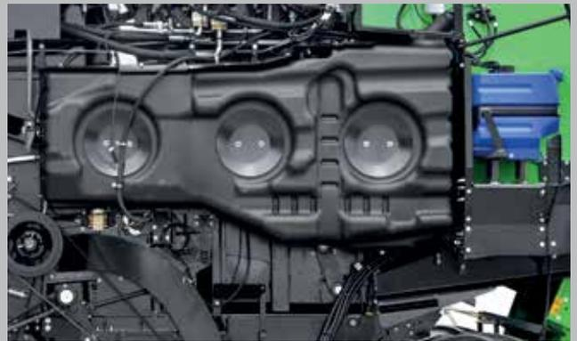
Depósito de combustible de 750 litros y depósito de AdBlue de 76 litros.
