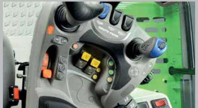
Fácil selección de los componentes de la cosechadora: cóncavo (delantero y trasero), cribas (superior o inferior) y turboseparador; y fácil ajuste de los parámetros con los 3 botones delanteros. Controles remotos del cabezal para seleccionar el modo y ajustar la altura y la presión al suelo.
