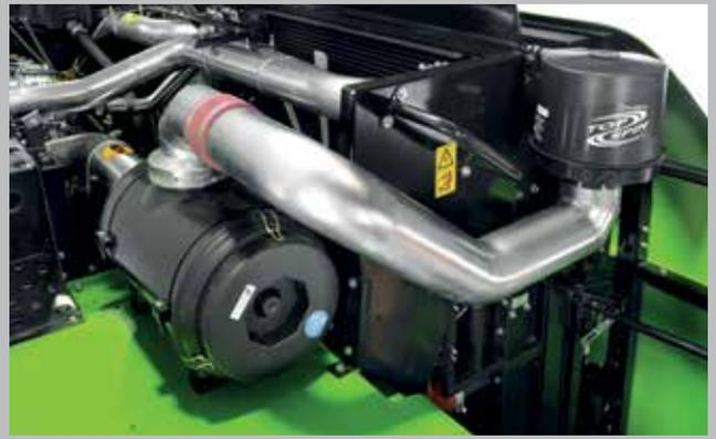
Filtro de aire de pre-limpieza del motor con sistema automático de autolimpieza.
