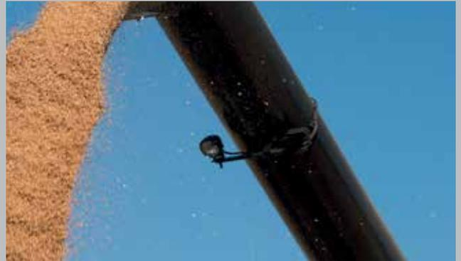
Luz integrada y una cámara en el tubo de descarga para comprobar las operaciones de descarga.
