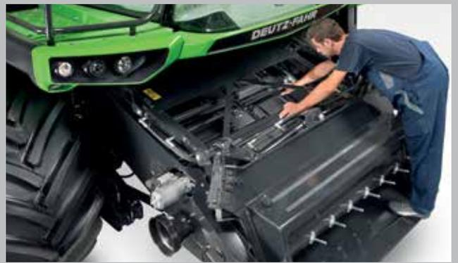
Fácil acceso para ajustar y comprobar las cadenas en la garganta de alimentación.
