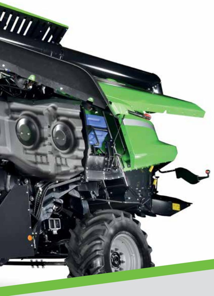
La amplia apertura de los paneles laterales permite un acceso completo a los principales sistemas de la cosechadora. En el lado izquierdo se encuentran las principales bombas y válvulas hidráulicas. La bomba hidrostática está acoplada directamente al motor para garantizar la máxima eficacia y fiabilidad.
