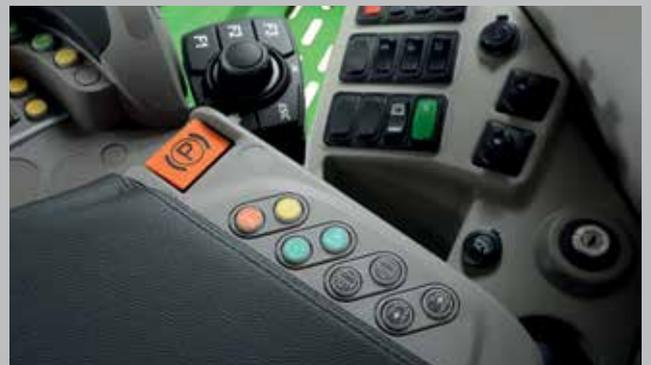
En la parte trasera, se encuentra el accionamiento de la doble tracción, el freno de estacionamiento, la apertura de la tolva, el MMI y las salidas USB.
