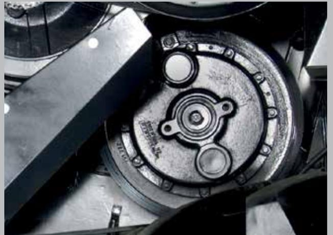
Reductor opcional de la velocidad del cilindro de trilla para ajustar el número de revoluciones del cilindro de 1250 a 625 rpm como velocidad máxima y de 420 a 210 rpm como velocidad mínima. Este conjunto está recomendado para la cosecha del maíz.
