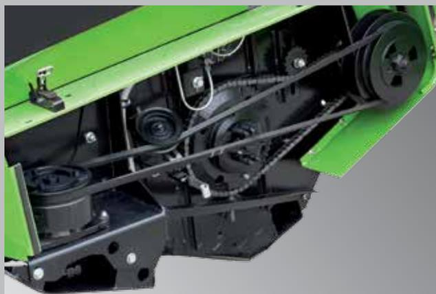
Sistema SCHUMACHER EASY CUT II: velocidad de corte de 1220 golpes por minuto, con mínimo desgaste y absorción de potencia.
