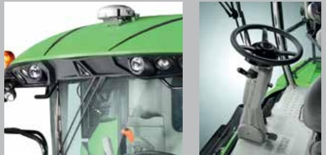
Fácil instalación de los sistemas de agricultura de precisión, plena integración de la dirección eléctrica, antena GPS, sensores de rendimiento e Isobus ECU.
