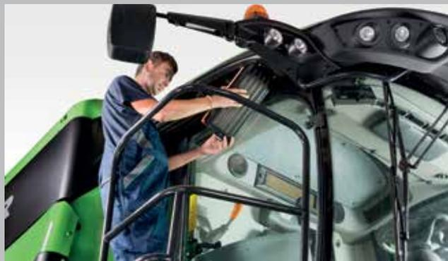
Desmontaje de los filtros de aire de la cabina sin necesidad de herramientas.
