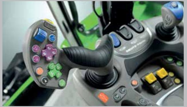
Control fluido de la transmisión con el COMMANDER STICK. El sentido se selecciona pulsando el botón de habilitación y moviendo la palanca hacia el sentido de avance deseado. Cuanto mayor sea el movimiento, más rápida será la velocidad. El control de crucero mantiene la velocidad óptima de trabajo, mientras que los pequeños ajustes se pueden hacer empujando o tirando del COMMANDER STICK para aumentar o reducir la velocidad, respectivamente.
