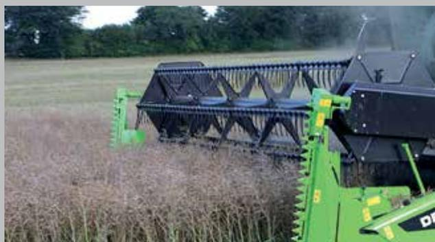
Para la cosecha de la colza existe un conjunto expresamente diseñado que se puede aplicar a los cabezales de corte estándar de hasta 7,2 m de DEUTZ-FAHR.
