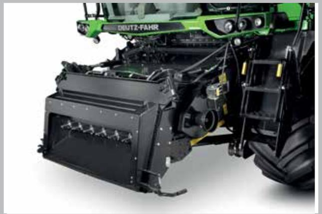
Todos los modelos se pueden equipar con la regulación electrohidráulica del ángulo de corte para adaptar de manera óptima el cabezal de corte. La función Autocontrol ajusta automáticamente el cabezal al terreno.
