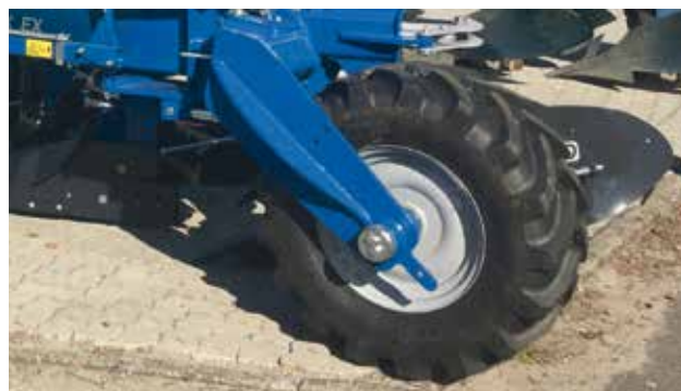
Roata profil tractor - 320/65x16 EX, VFEX, VFEX On-land. Control mecanic al adancimii si coborare asistata cu ambreiaj
