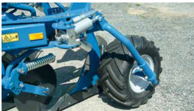
Roata profil tractor CX, DX, VFCX, VFCXP Control al adancimii mecanic, coborare hidraulica.
