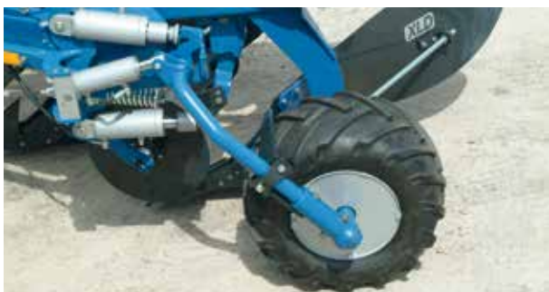
Control hidraulic al adancimii pentru roti profil tractor
