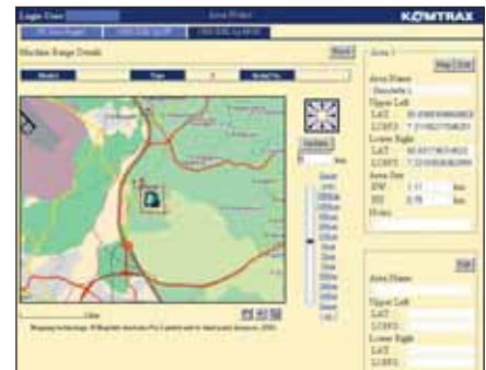
Seguridad añadida – La característica “bloqueo del motor” permite programar cuando se puede encender una máquina. Con la opción “geo-fence”, KOMTRAX™ le envía una notificación cada vez que su máquina traspasa una determinada área de operación predeterminada.
