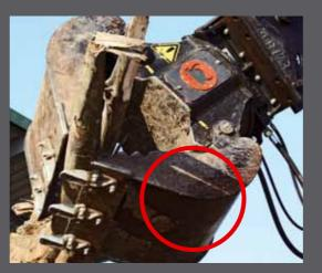
Der Geräteboden ist rundum geschlossen. So wird die innenliegende Technik vor Beschädigungen Abbruchdurch material wie Eisen, Steine oder Hölzer geschützt.
