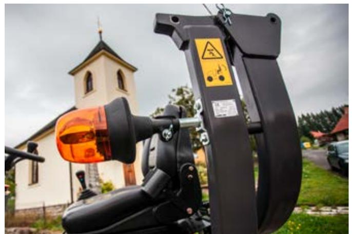
Abklappbares ROPS-Schutzdach für den einfachen Transport
