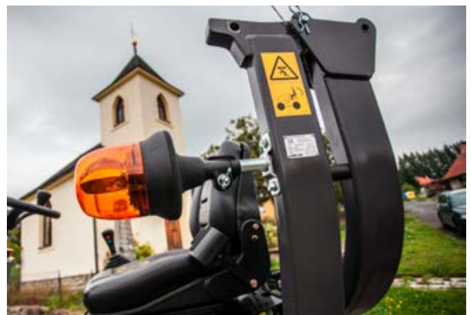
Abklappbares ROPS-Schutzdach für den einfachen Transport
