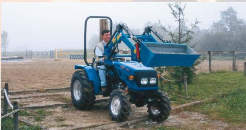
de 24 litres. Une pompe fournissant un débit de 30 litres est proposée en alternative (option). La capacité de relevage aux rotules est de 700 kg. Il est également prévu (option) un relevage à contrôle électronique disposant des fonctions suivantes : contrôle d'effort, contrôle de position, contrôle mixte et mémorisation d'une hauteur de montée.
