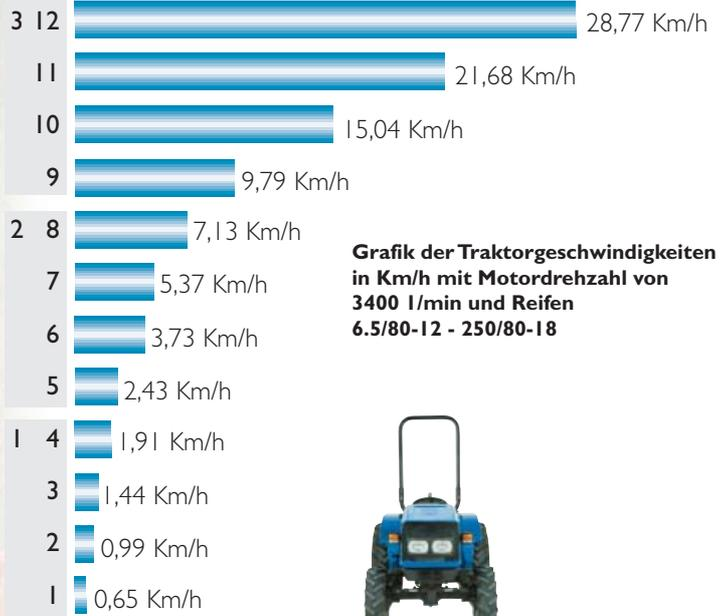
Grafik der Traktorgeschwindigkeiten in Km/h mit Motordrehzahl von 3400 1/min und Reifen 6.5/80-12 - 250/80-18
