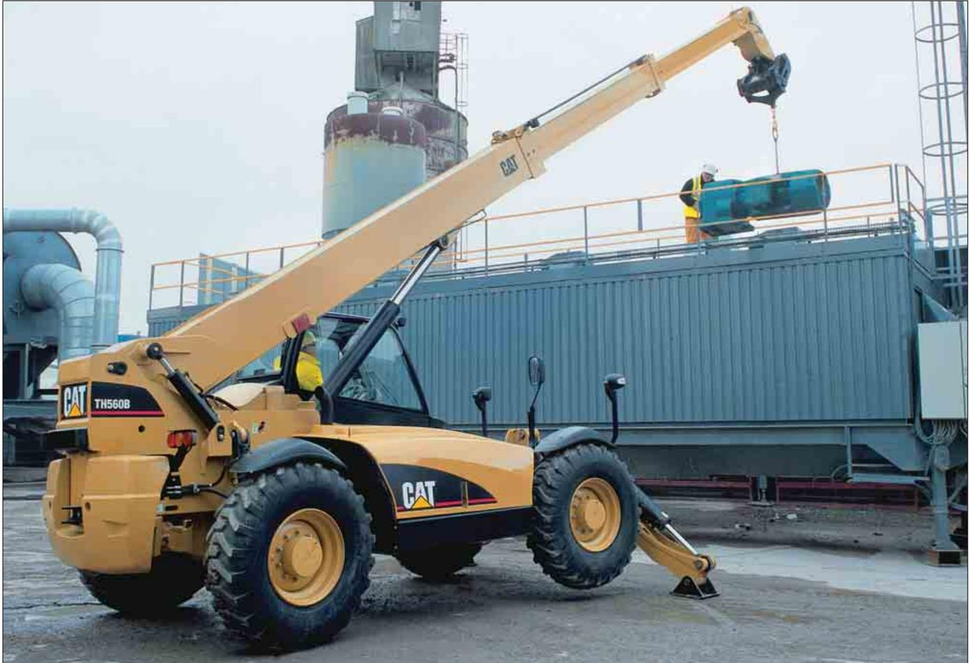
**Hubhöhe.** Mit dem Teleskopausleger des TH560B lassen sich zum Beispiel Mauerziegel, Dacheindeckungen und Fachwerkträger in Sekundenschnelle auf bis zu 13,50 m Höhe anheben und präzise positionieren.
