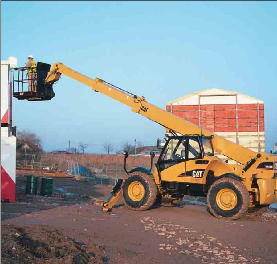
**Zusatzhydraulik.** Soll der TH560B in Verbindung mit hydraulischen Anbaugeräten eingesetzt werden, kann man die serienmäßige Zusatz-Hydraulik zum Ansteuern verwenden. Darüber hinaus ist ein Konstantstrom-Hydraulikkreis lieferbar wie er beispielsweise für Kehrbesen benötigt wird.
