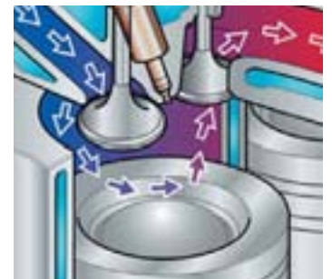
Effizienter Querstromkopf für maximale Leistung.
