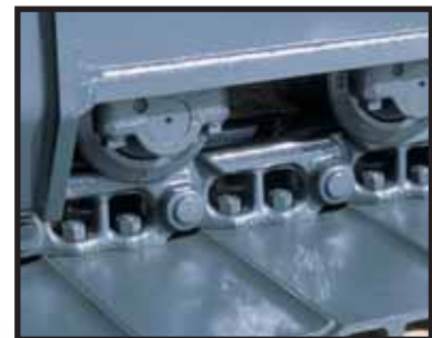
Beim PC130-7 kommen verstärkte Kettenglieder mit Mittelsteg zum Einsatz.
