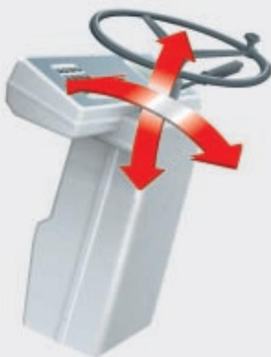
**Leichter Ein- und Ausstieg und stets optimale Sitzposition durch die verstellbare Lenksäule**
