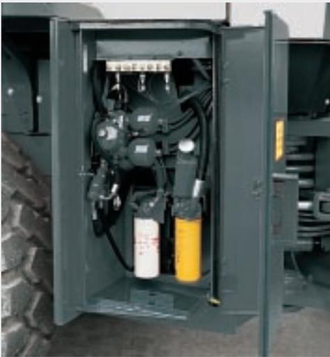
In der ausklappbaren Servicesation befinden sich Messanschlüsse und Ölfilter. Die normalerweise über das Gerät verteilten Schmierstellen sind hier in einer Leiste zusammengefasst und bequem vom Boden aus erreichbar.
