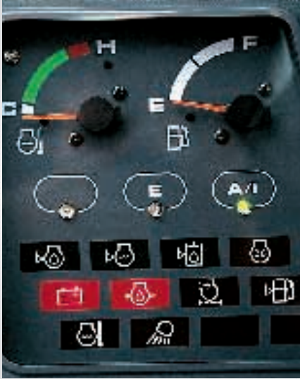
Elektronische Füllstandskontrolle für Motoröl-, Kühlwasser- und Hydraulikölstand
