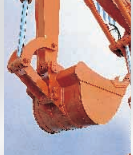
Einteilige Tieflöffelumlenkkoppel Großer Löffelschließwinkel verhindert Materialverlust beim Beladen eines LKW.
