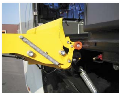
S983 Parapiède automatico sul bordo anteriore del pianale
