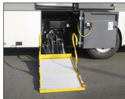
S981 DH-RB con alimentatore idraulico laterale, per situazioni di montaggio in cui l'apertura della porta è sfasata rispetto allo spazio di installazione della sponda
