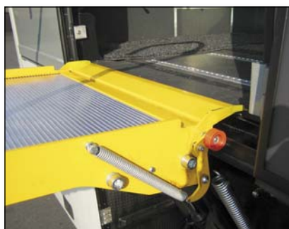
S983 Parapiède automatico sul bordo anteriore del pianale
