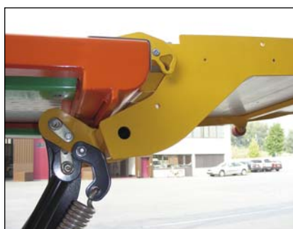
S982 Attacco del pianale alto per piano di carico più spesso
