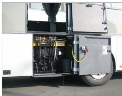
S981 DH-RB con alimentatore idraulico laterale, per situazioni di montaggio in cui l'apertura della porta è sfasata rispetto allo spazio di installazione della sponda
