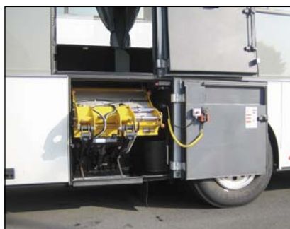
S981 DH-RB con alimentatore idraulico laterale, per situazioni di montaggio in cui l'apertura della porta è sfasata rispetto allo spazio di installazione della sponda
