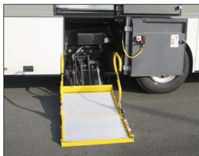
**S981** DH-RB con cambio lateral hidráulico para situaciones de montaje en las que la apertura de puerta está compensada con el espacio de montaje de la plataforma
