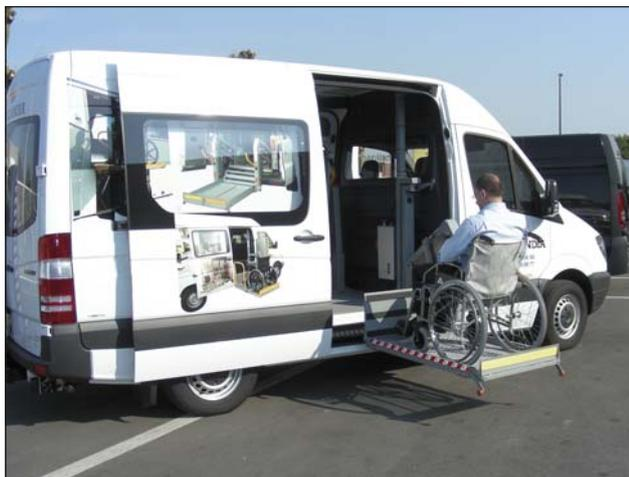
**DH-P10** 250 kg - 1 brazo de elevación lineal
