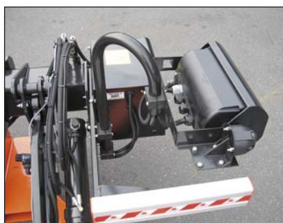
S411.LM Support réglable pour le boîtier de commande
