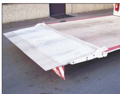
S239.LSU Plateau pliable en 2 parties, avec des articulations renforcées
