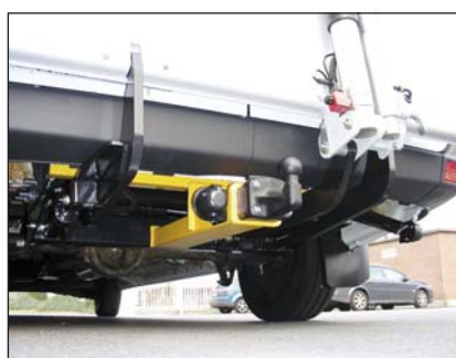
S371 Préparation pour support d'attelage (pour boule ou crochet démontables non fournis)
