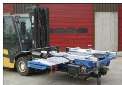
**S410** Hayon prémonté sur un cadre de transport pour montage rapide
