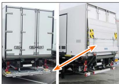
**S244** Fermeture du plateau en position verticale derrière la carrosserie du véhicule
