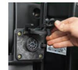
□ ISOBUS Steckdose für den Anschluss der Gerätesteuerung.
