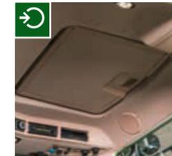
□ Die im Dachhimmel integrierte Luke bietet eine zusätzliche Belüftungsmöglichkeit an heißen Tagen.
