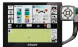
Mit Fendt VarioGuide halten Sie die Spur in zwei Genauigkeitsstufen mit +/- 20 cm (VarioGuide Standard) und +/- 2 cm (VarioGuide RTK). Neu ist die flexible Auswahl verfügbarer Empfänger und Korrekturdienste.
