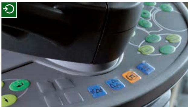
Folientaster für Geräteverriegelung und Aktivierung der Dämpfung.
