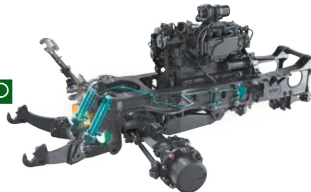
Die Kraftheber werden über das Varioterminal eingestellt und per Kraftheberbedienmodul, Multifunktionsjoystick oder die externe Bedienung an den hinteren Kotflügeln oder an der Front betätigt.
