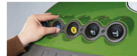
□ Mit der externen Ventilbedienung betätigen Sie den Heckkraftheber, ein Ventil und die Zapfwelle direkt an den hinteren Kotflügeln. Auch bei der externen Betätigung der Heckzapfwelle kann automatisch eine voreingestellte Motordrehzahl angefahren werden.
