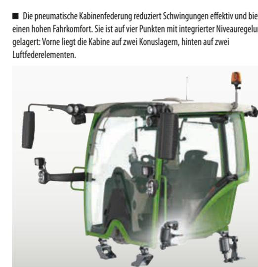
■ Die pneumatische Kabinenfederung reduziert Schwingungen effektiv und bietet einen hohen Fahrkomfort. Sie ist auf vier Punkten mit integrierter Niveauregelung gelagert: Vorne liegt die Kabine auf zwei Konuslagern, hinten auf zwei Luftfederelementen.
