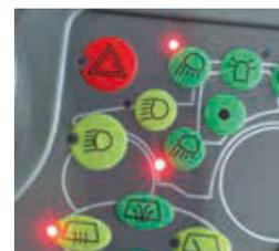
■ Die Beleuchtung lässt sich dank der übersichtlichen Darstellung sehr einfach einstellen. Mit dem Einknopfsystem können alle zuvor eingestellten Arbeitsscheinwerfer über nur einen Druck am Folientaster bequem und schnell geschaltet werden.
