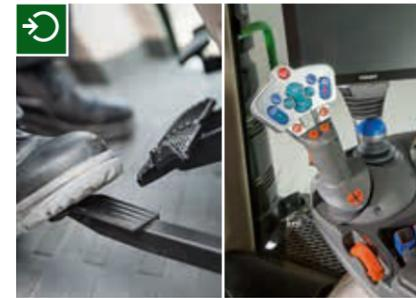
Fahrtrichtungswechsel erfolgen wahlweise per Fahrhebel oder Reversierhebel am Lenkstockschalter. Besonders praktisch: die integrierte Stop-and-Go Funktion.
