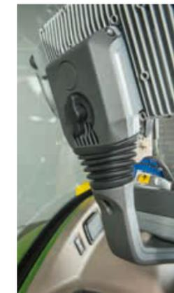
In jede Richtung verstellbar ist das Varioterminal durch den neuen Halter mit Kugelgelenk.
