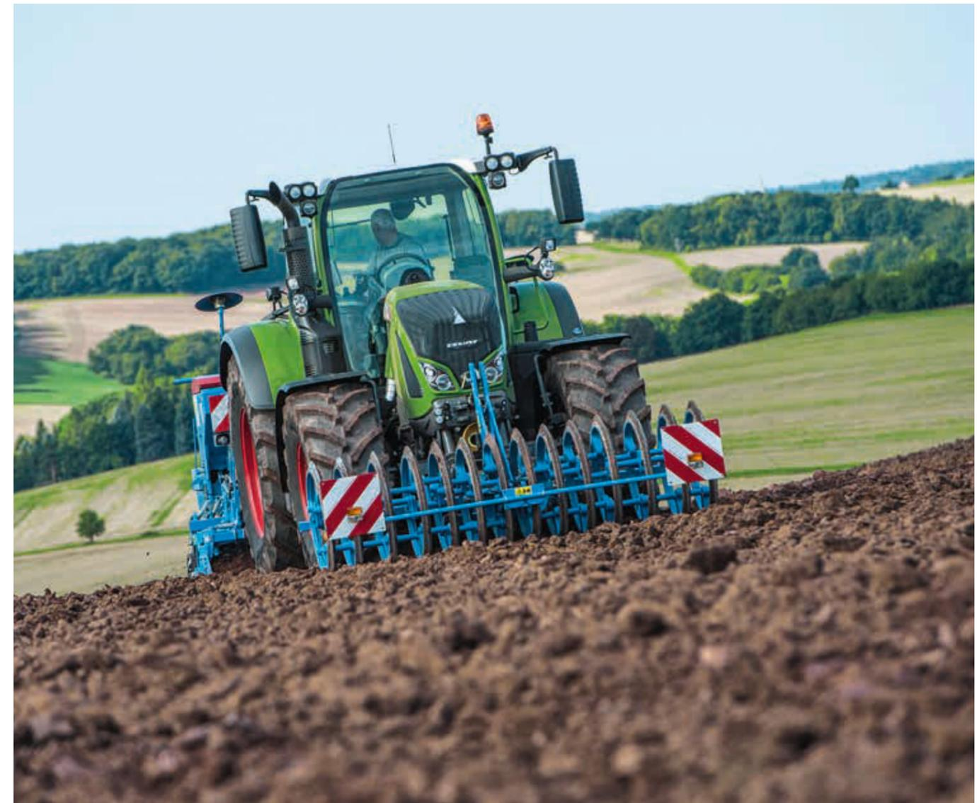
Die tragende Rolle beim Fendt 700 Vario übernimmt der robuste Gussrahmen bei einem zulässigen Gesamtgewicht von 14 Tonnen. Mit einer hohen Nutzlast von 6.200 kg hat der kompakte Großtraktor für schwere Anbaugeräte reichlich Reserven.
