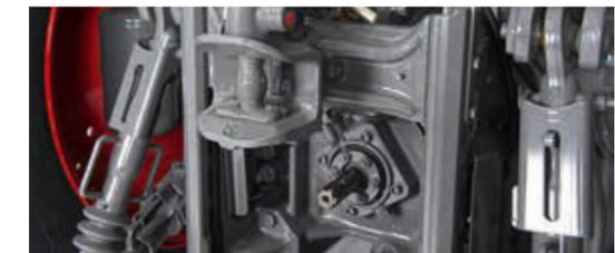
■ Heckzapfwelle mit den Geschwindigkeiten 540, 540E, 1000 und 1000E U/min. Besonders komfortabel ist die externe Zapfwellenbetätigung am Heck.
