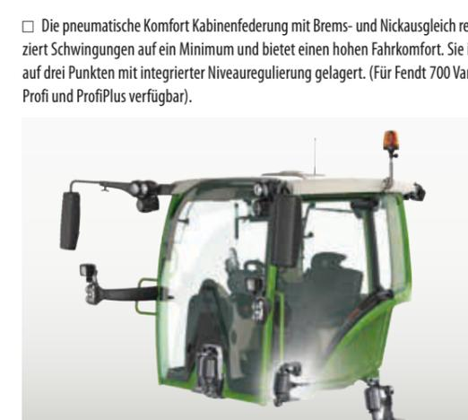
□ Die pneumatische Komfort Kabinenfederung mit Brems- und Nickausgleich reduziert Schwingungen auf ein Minimum und bietet einen hohen Fahrkomfort. Sie ist auf drei Punkten mit integrierter Niveauregulierung gelagert. (Für Fendt 700 Vario Profi und ProfiPlus verfügbar).
