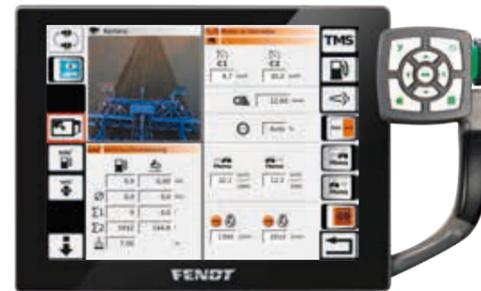
Beim Einsatz mit ISOBUS-fähigen Spritzen, Düngestreuern oder Sämaschinen schaltet SectionControl jetzt bis zu 36 Teilbreiten.
