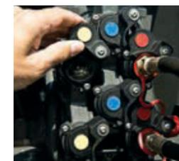
□ Die selbstschließenden Ventilkappen der DUDK-Kupplungen schützen sicher vor Verschmutzungen wie Staub oder Wasser.
