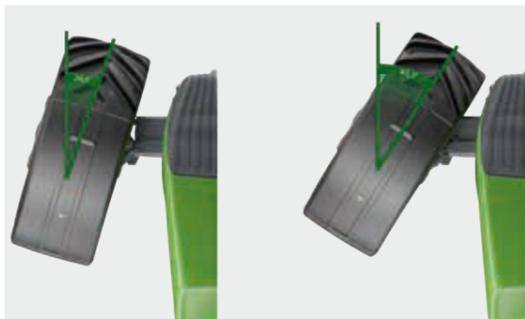
Im Verhältnis zur Standardeinstellung benötigt man mit VarioActive ca. 60% weniger Lenkradumdrehungen für den gleichen Radeinschlag. Sie profitieren durch die schnellere Reaktion der Lenkung mit VarioActive bei engen Wendevorgängen am Vorgewende oder bei Frontladerarbeiten. Zur Fahrsicherheit ist diese nur von 0 – 25 km/h einsetzbar.
