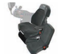
□ Der luftgefederte Super-Komfortsitz ist mit einer anpassungsfähigen Rückenlehne, Sitzheizung, Niederfrequenzfederung, pneumatischer Lendenwirbelstütze und einer komfortablen Armlehnenverstellung ausgestattet. Ein Drei-Punkt-Sicherheitsgurt ist verfügbar.
