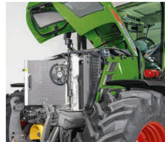
Weniger Aufwand, mehr vom Feierabend: Das kompakte Kühlpaket ist sehr gut zugänglich und lässt sich dank der großen Abstände zwischen den Kühlern und dem ebenen Kühlerboden einfach und schnell reinigen.
