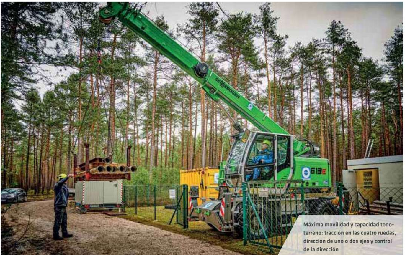
Alta estabilidad con un soporte compacto cuadrado de 4 m x 4,35 m
