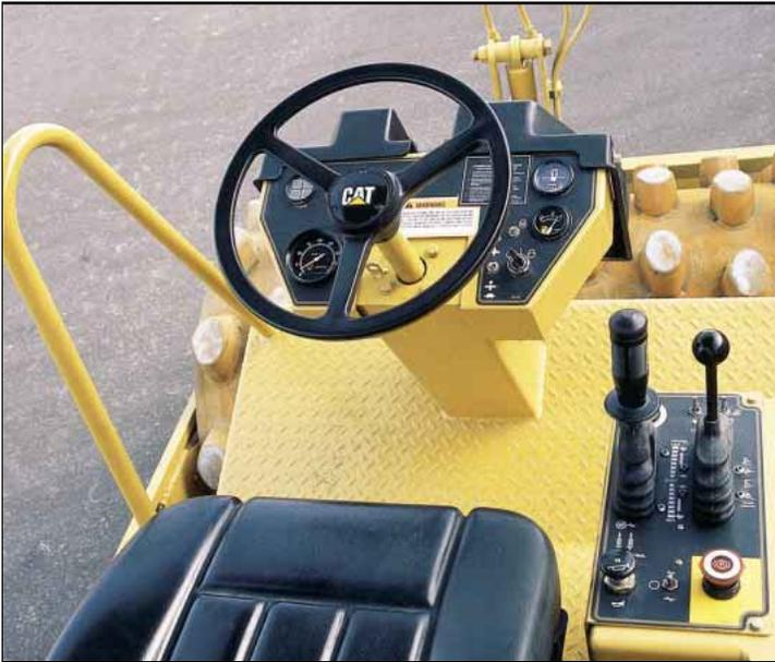
**Einhebelbedienung** zur mühelosen Steuerung von Fahrtrieb und Vibrationssystem.
