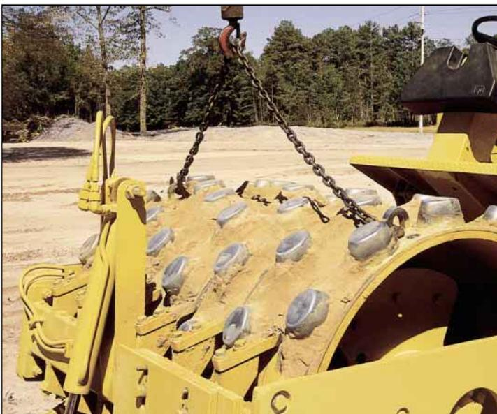
**Zweiteiliger Anschraubsatz** mit 90 mm hohen Stampffüßen. Jede der beiden Bandagenhälften wiegt 453 kg.
