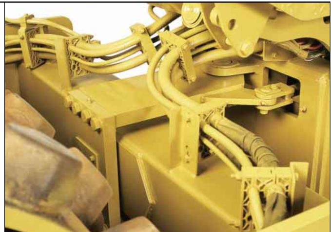
**Sorgfältige Verlegung und Befestigung der Hydraulikschläuche** an stabilen Kunststoffhaltern.
