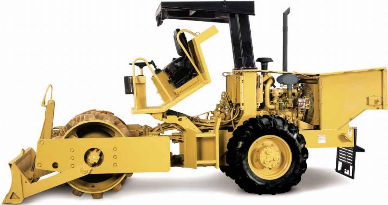
**Bodennahe Anordnung** der täglichen Wartungsstellen und des Kraftstoff-Einfüllstutzens.
