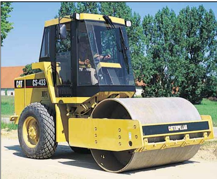
**Schalldruckpegel von 75 dB(A)** für weitgehenden Lärmschutz des Fahrers.
