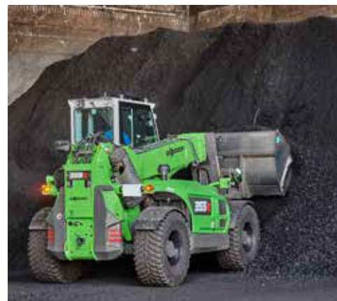
Máx. 85 kN, fuerza de tracción / fuerza de cizallamiento
