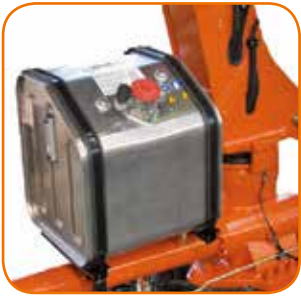
Ölbehälter Oil Tank
