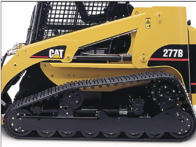
**Konstruktion.** Aus den 48 Aufstandspunkten der Leit- und Laufräder ergibt sich eine sehr gleichmäßige Gewichtsverteilung über die gesamte tragende Kettenlänge.
