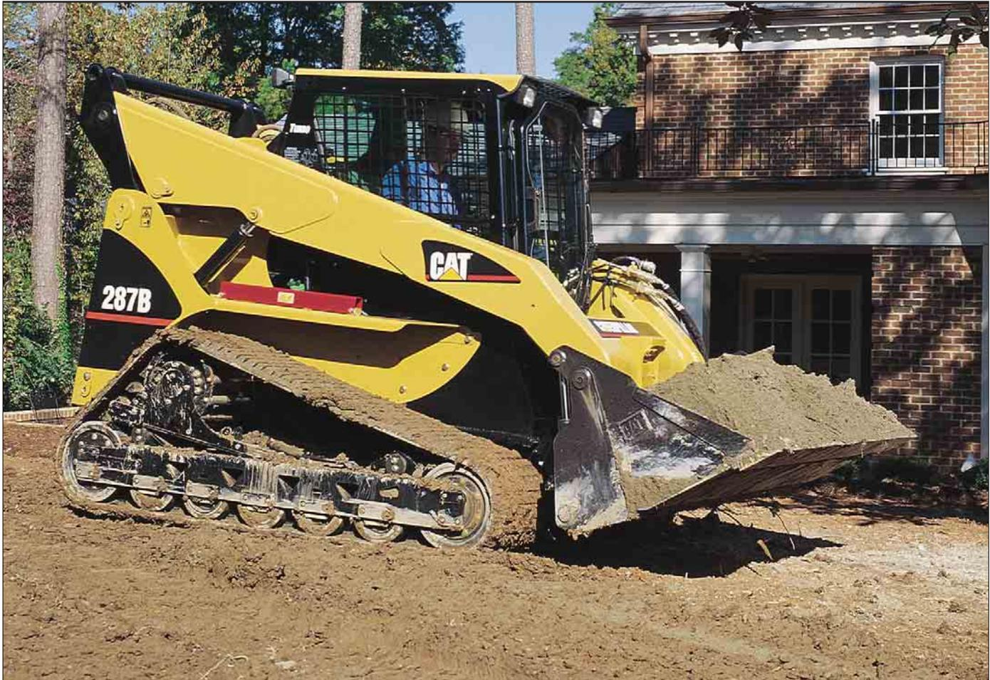
**Dieselmotor.** Mit einer Nennleistung von 59 kW stellt der Cat 3044C T reichlich Leistung für alle vorkommenden Deltalader-Einsätze zur Verfügung. Der robuste, zuverlässige und drehmomentstarke Vierzylinder-Turbomotor unterschreitet die Emissionsgrenzwerte gemäß EU-Richtlinie 97/68/EG, Stufe II.
