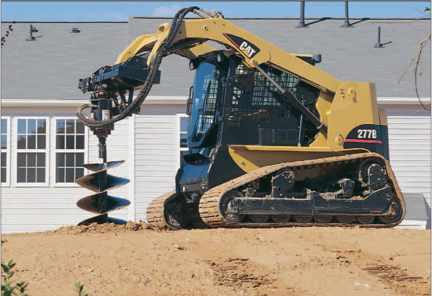
**Steuerung.** Die Proportionalsteuerung der Hydraulik erlaubt ein feinfühliges Positionieren der Arbeitsausrüstung.
