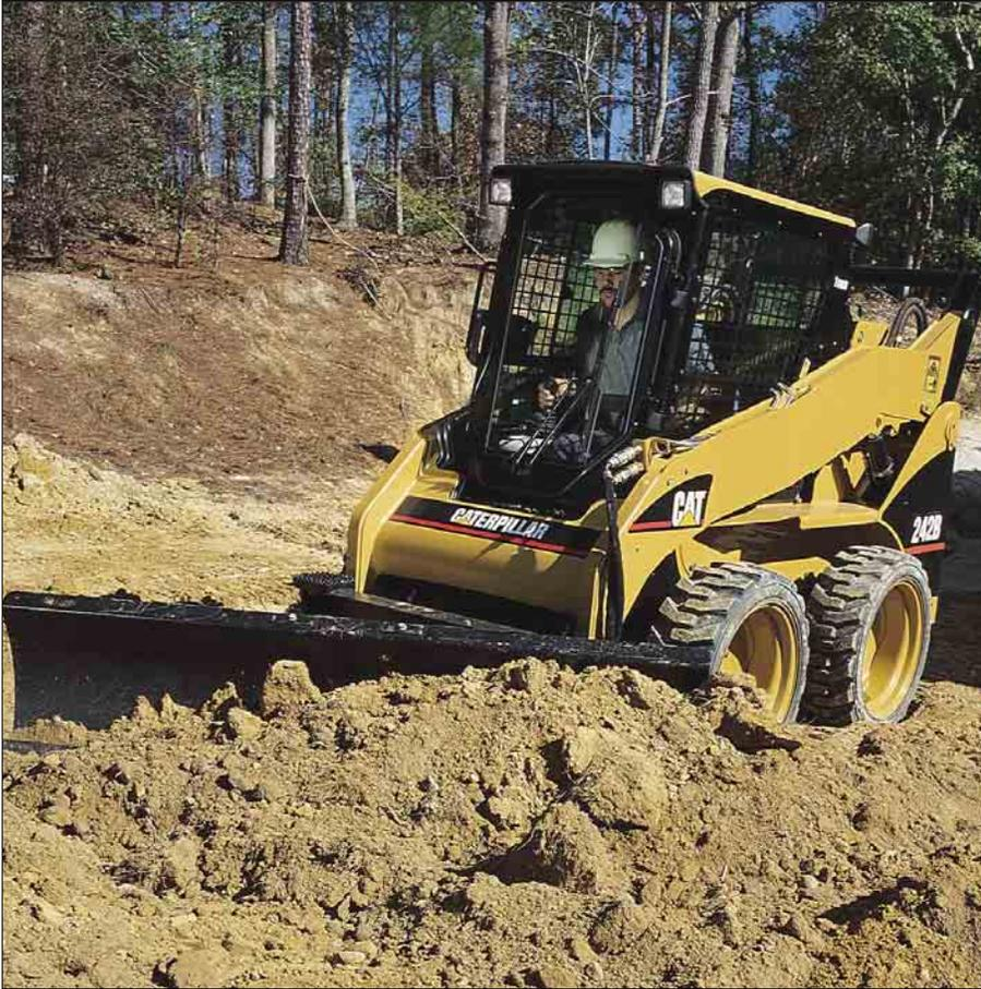
**Dieselmotor.** Mit einer Nennleistung von 37 bzw. 43 kW stellt der Cat 3024C reichlich Leistung für alle vorkommenden Einsätze zur Verfügung. Der robuste, zuverlässige und drehmomentstarke Vierzylinder, der im 242B mit Abgasturbolader ausgerüstet ist, unterschreitet die Emissionsgrenzwerte gemäß EU-Richtlinie 97/68/EG, Stufe II.
