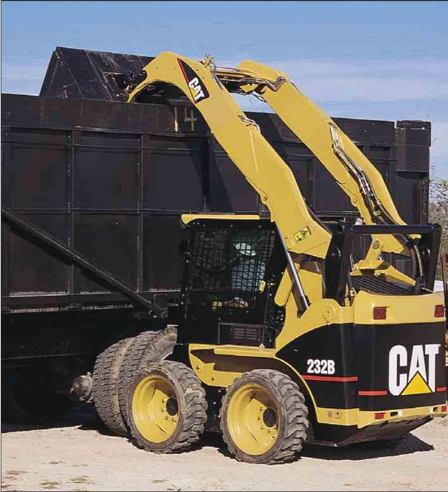
**Hubeinrichtung.** Die Hubeinrichtung mit Vertikalhubkinematik, die sich trotz des relativ geringen Eigengewichts durch eine robuste Bauweise auszeichnet, verhilft den Maschinen zu exzellenter Leistungsfähigkeit und beeindruckender Haltbarkeit.
