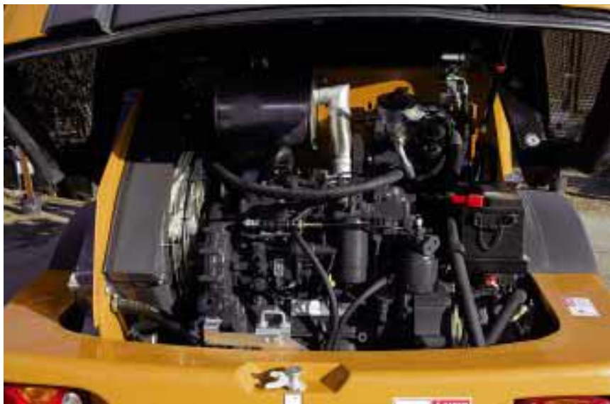
Le capot escamotable simplifie l'accès au compartiment moteur.
