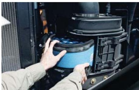
Le filtre à air est facile à retirer, et la poussière est aspirée et rejetée dans le pot d'échappement.
