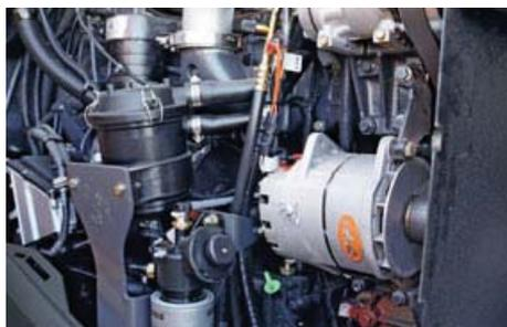
Le filtre à carburant et les points d'entretien pour l'huile moteur sont aisément accessibles des deux côtés de la machine ; les autres filtres se trouvent derrière les marches de droite.
