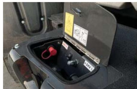
Commutateur d'ouverture du capot et coupe-batterie. En cas de batterie déchargée, l'installation de cables de démarrage est facilitée et sécurisée.
